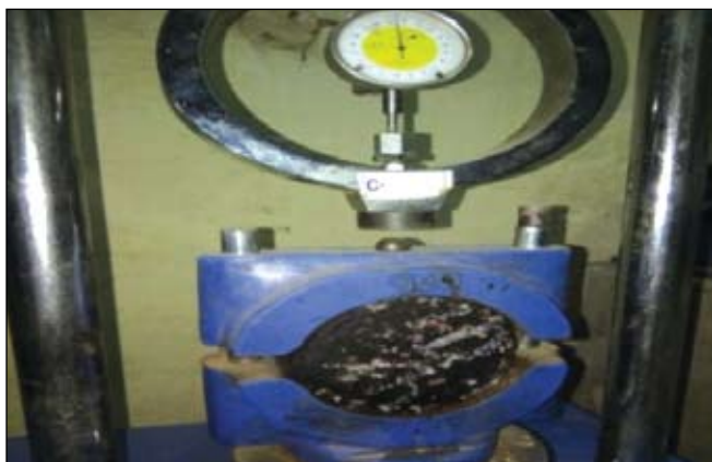
चित्र 43 – मार्शल स्थायित्व परीक्षण
