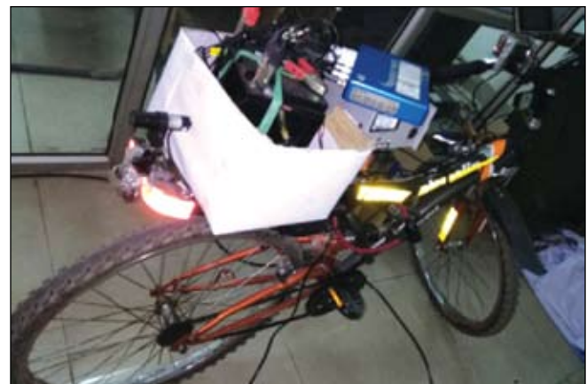
चित्र 78: विकसित बाइक आधारित कम सड़क परिसंपत्ति प्रबंधन प्रणाली के प्रारूपिक दृश्य
