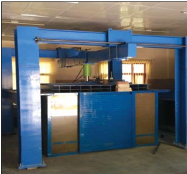
चित्र 13 – अनेक अधोगामी के प्रोटोटाइप के सृजन हेतु मॉडल परीक्षण टैंक
