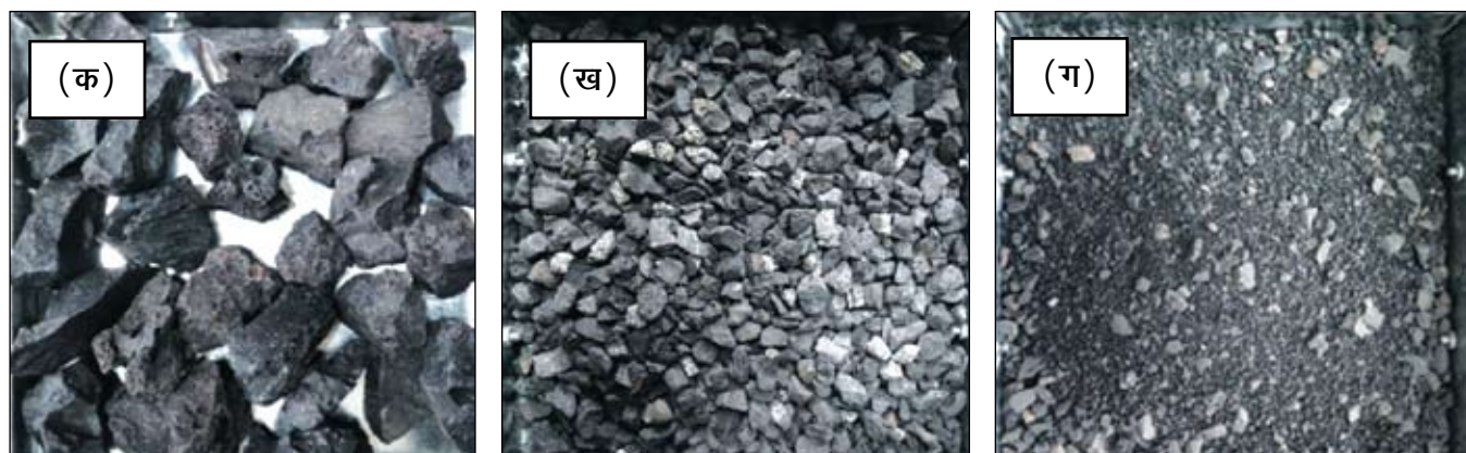
चित्र 28 – (क) 40 मिमी वातानुकूलित धातुमल (ख) 20 मिमी वातानुकूलित धातुमल और (ग) 10 मिमी जलयुक्त दानेदार के दृश्य
