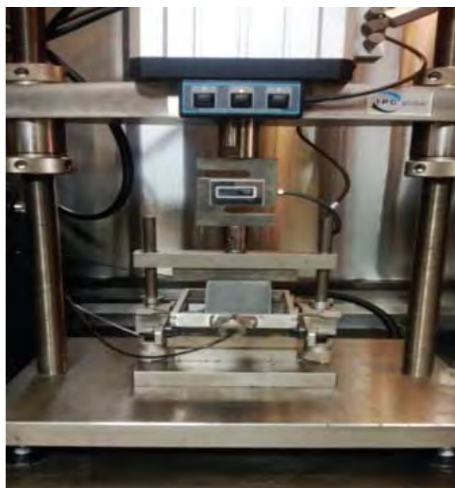
चित्र 5 : सीमेंट स्थिरीकृत सामग्री के रेसिलिएंट मॉड्यूलस परीक्षण हेतु संस्थापना
