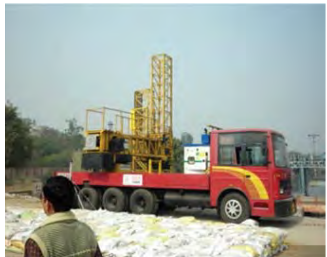
चित्र 118 : एमबीआइयू के प्रयोग से सेतु का भार परीक्षण
