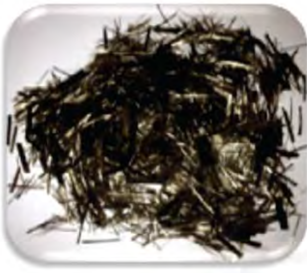
चित्र 52 : अन्तरायित (चौप) बसाल्ट तंतु
