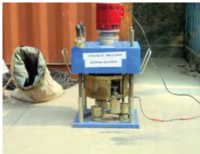
चित्र 67 : सड़क पर अपघर्षण परीक्षण
