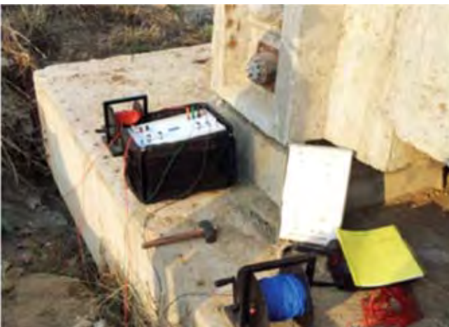
चित्र 117 : प्रतिरोधकता परीक्षण के द्वारा कूप आधार की गहराई का निर्धारण
