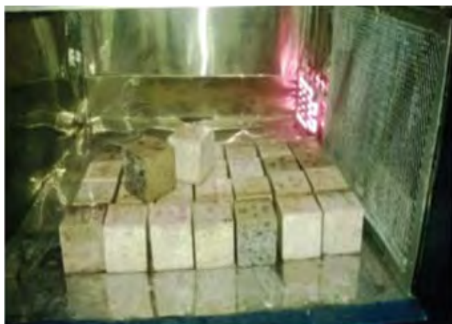
चित्र 106 : ओवन में आस्तरित कंक्रीट नमूने के सामर्थ्य का परीक्षण
