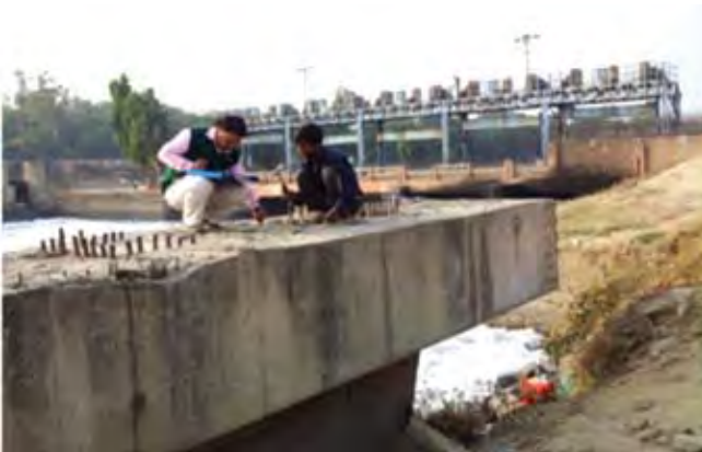
चित्र 116 : प्रभाव प्रतिध्वनि परीक्षण के द्वारा कूप आधार की गहराई का निर्धारण
