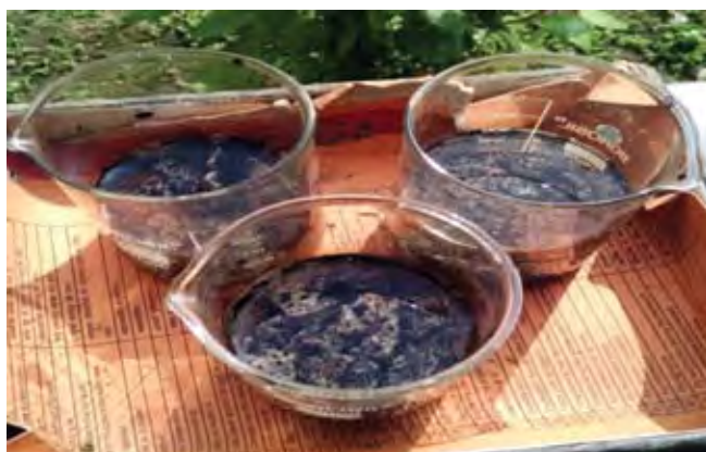
चित्र 89 : निर्लेपन परीक्षण के बाद पाए गए निर्लेपित संस्तर मिलावे का प्रारूपिक दृश्य
