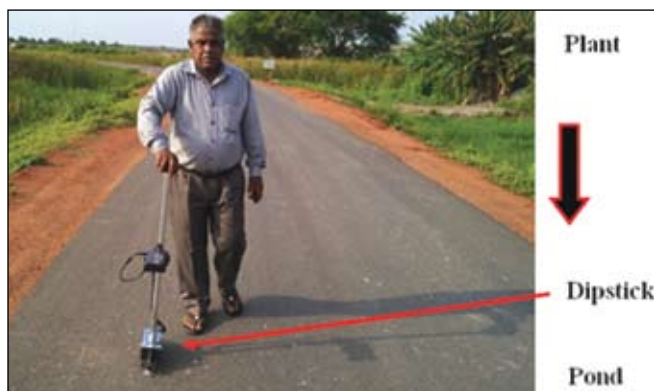
चित्र 13 : फॉस्फोजिप्सम सड़क के डिपस्टिक का उपयोग करके खुरदरापन का मापन
