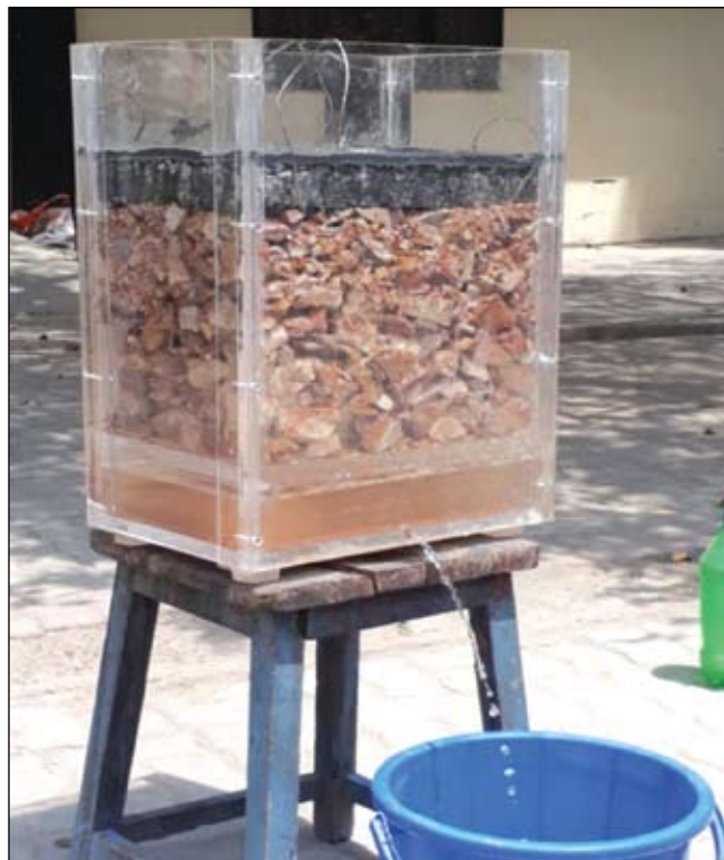
चित्र 40 : छिद्रपूर्ण कुट्टिम की पारगम्यता का प्रदर्शन
