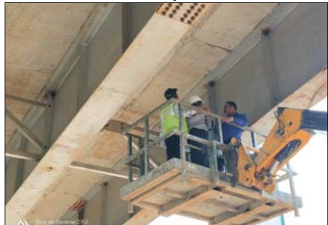
चित्र 64 : लोड परीक्षण के दौरान सुपर स्ट्रक्चर के निरीक्षण का एक दृश्य
