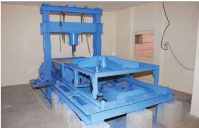
चित्र 15 : वर्तमान अध्ययन के लिए प्रयुक्त पुलआउट उपकरण का अग्र दृश्य
