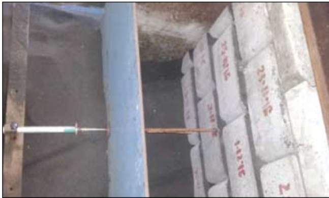
चित्र 18 : कनेक्शन सामर्थ्य परीक्षण तंत्र का सामान्य दृश्य
