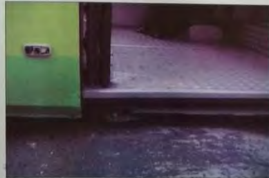
चित्र 78 : सड़क सतह तथा लो फ्लोर बस के पिछले दरवाजे के बीच लगभग शून्य अंतराल
