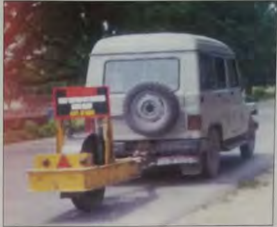
चित्र 62 : खुरदुरापन मापन के दौरान जीप के द्वारा खींचे जा रहे स्वचालित सड़क असमतलता अभिलेखी (एआरयूआर) का एक दृश्य
