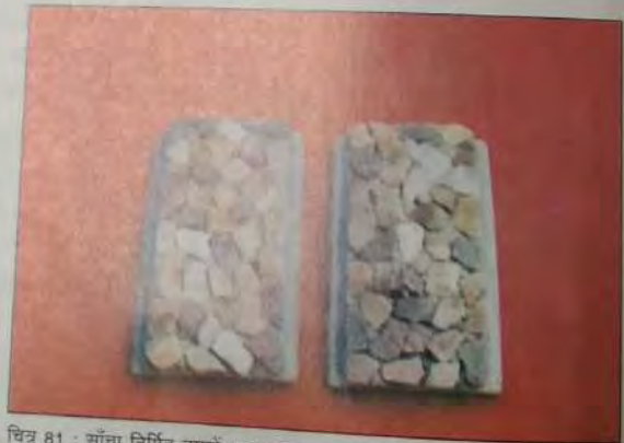
चित्र 81 : साँचा निर्मित नमूनों का एक गहन दृश्य
