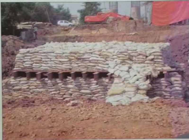
चित्र 22 : प्रस्तर स्तम्भ से संशोधित भूमि पर भार परीक्षण प्रगति पर
