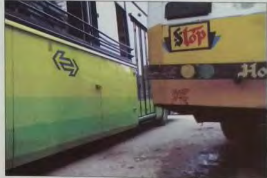
चित्र 77 : सड़क सतह के दृष्टिकोण से सामान्य डीटीसी बस तथा लो फ्लोर बस के बीच अंतराल दूरी
