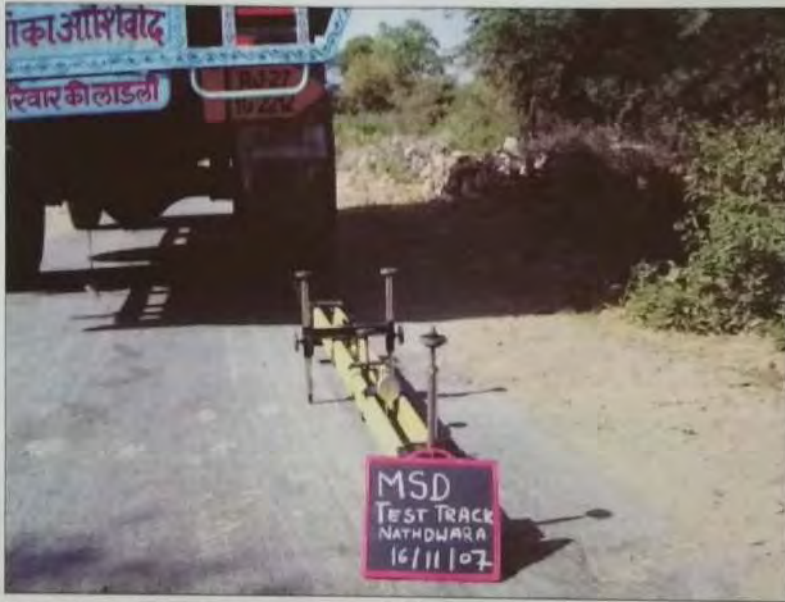
चित्र 48 : बैकलमेन बीम के द्वारा संरचनात्मक क्षमता का मूल्यांकन
