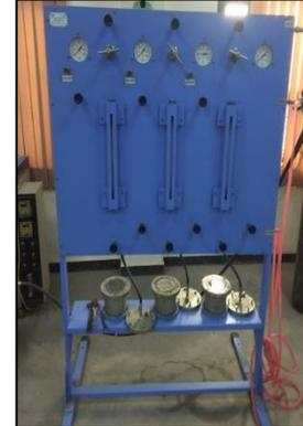
चित्र 16: आरसीपीटी परीक्षण चित्र 17: आनम्यता सामर्थ्य चित्र 18: जल पारगम्यता परीक्षण
