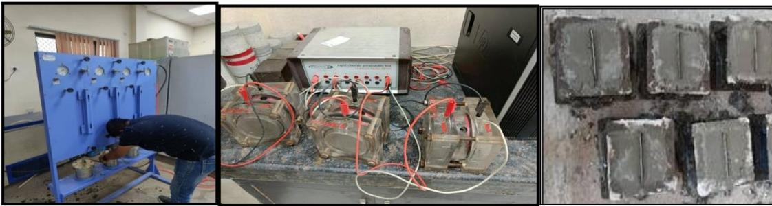
चित्र 21: (ए) जल पारगम्यता परीक्षण (बी) आरसीपीटी परीक्षण (सी) स्व-उपचार परीक्षण के लिए नमूना
