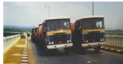
चित्र 2 ब्रह्मपुत्र सेतु पर भार परीक्षण
