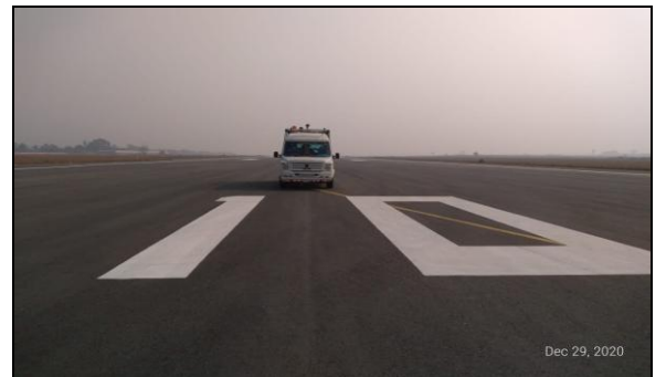
चित्र 9. हवाईअड्डे पर नेटवर्क सर्वेक्षण वाहन के प्रयोग से कुट्टिम स्थिति सर्वेक्षण
