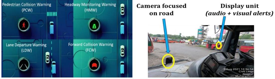
चित्र 10: नागपुर बसों में स्थापित उन्नत चालक सहायता प्रणाली (एडीएस) का चित्रण
