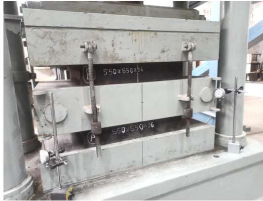
चित्र-5: द्वि-अक्षीय इलास्टोमेरिक बेयरिंग परीक्षण मशीन में कंप्रेसिव स्टिफनेस परीक्षण प्रक्रियाधीन है।
