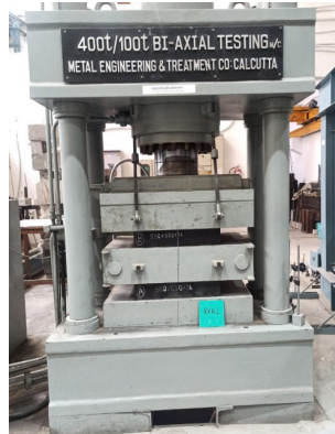
चित्र-2: द्वि-अक्षीय इलास्टोमेरिक बेयरिंग परीक्षण मशीन का सामान्य दृश्यपरीक्षण
