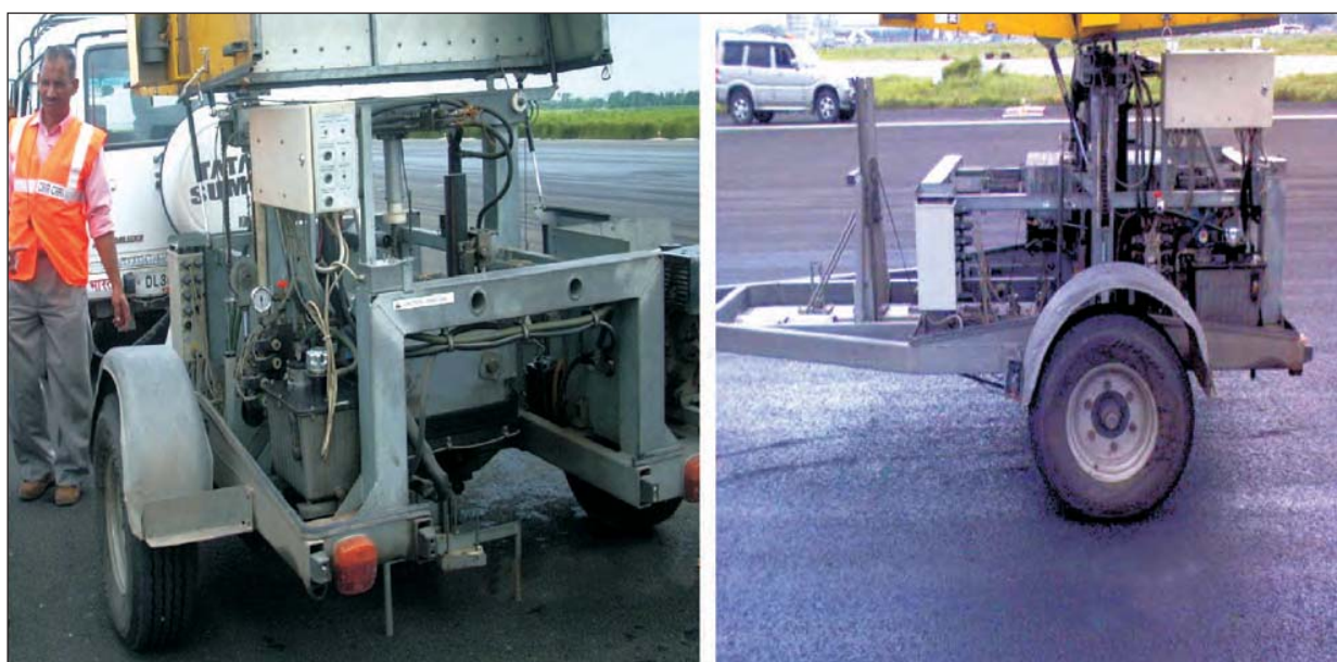
चित्र 58 हवाई पट्टी कुट्टिम पर एफडब्लूडी विक्षेप मापन
