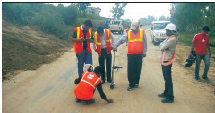
चित्र 33 रा.मा. 1 पर पहुँच 3 पर डिपस्टिक से रूक्षता मापन का चल रहा कार्य
