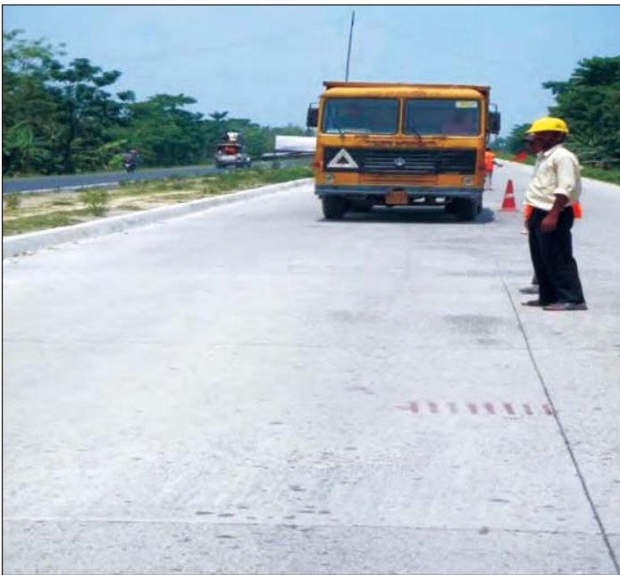
चित्र 40 यंत्रीकृत कुट्टिम का भार परीक्षण
