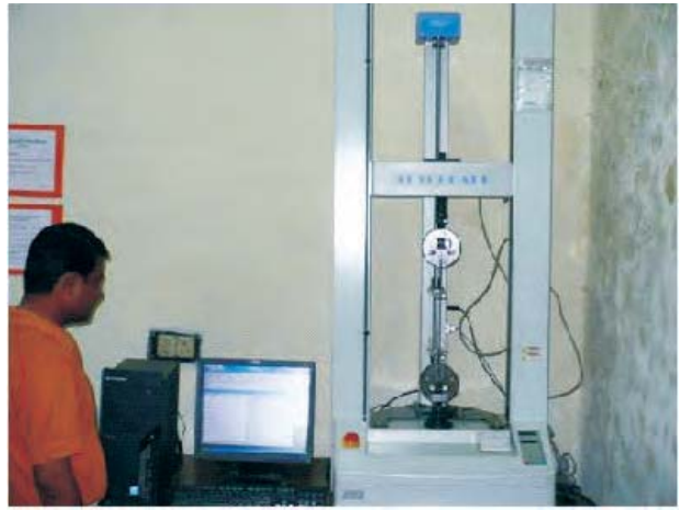
(ख) पत्ती संवरण का तनन परीक्षण
