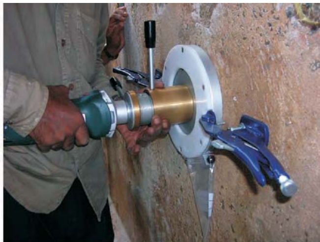
(घ) क्लोराइड के निर्धारण हेतु कंक्रीट चूर्ण निष्कर्षण
