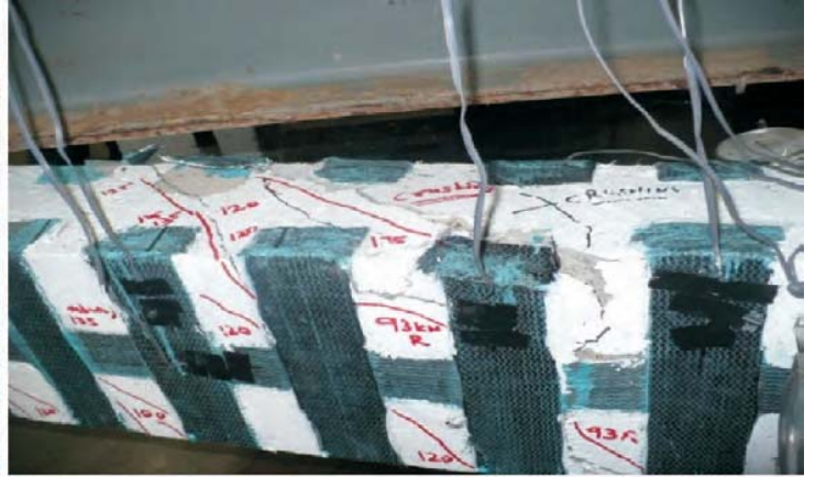
चित्र 62 परम बल आघूर्ण 14.14 kN पर पीटीआर-1 की विफलता
