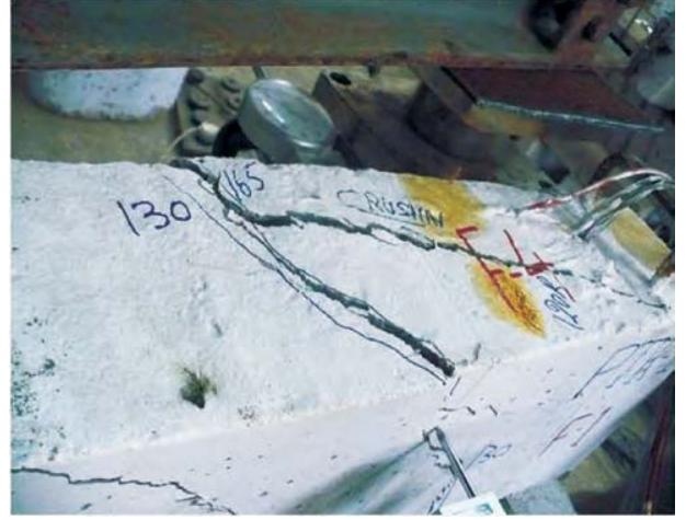
चित्र 62 परम बल आघूर्ण 14.14 kN पर पीटीआर-1 की विफलता
