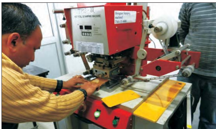
चित्र 115 काला अम्ब (हिमाचल प्रदेश) में मैसर्स शिमनित उल्हा प्रा. लि. की निर्माण इकाई में होलोग्राम लगाने की प्रक्रिया
