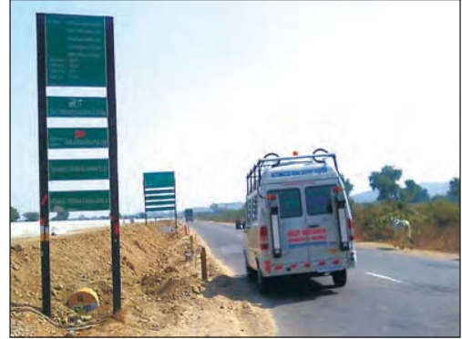
चित्र 50 एआरएसएस के प्रयोग से कुट्टिम सतह रूक्षता का मापन
